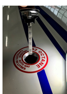
Peilstok rechter tank (niets waarneembaar)
