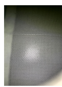
Bodem rechtertank onder vuldop, gele gloed is brandstof
