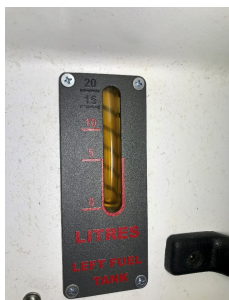
Tankindicatie linker tank (leeg).
